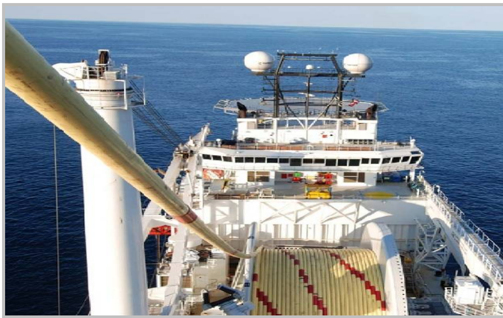
FOTO 5.2.1.1-3: Carretéis de tubos flexíveis sendo enrolados no navio
